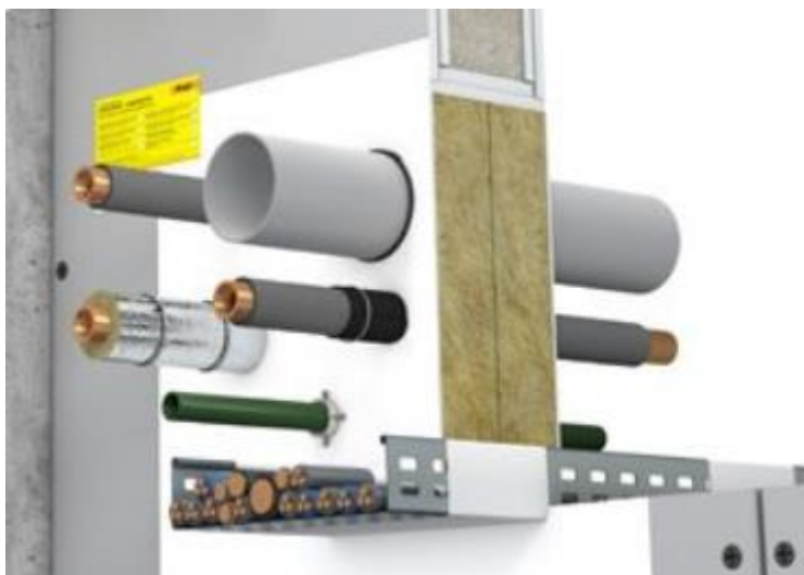
Abbildung 2-3: Darstellung eines Weichschotts bei Durchdringungen
