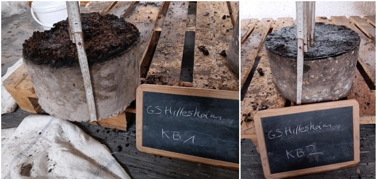
Abbildung 3: Betonkerne KB 1 und KB 2 mit Resten Dachaufbau
